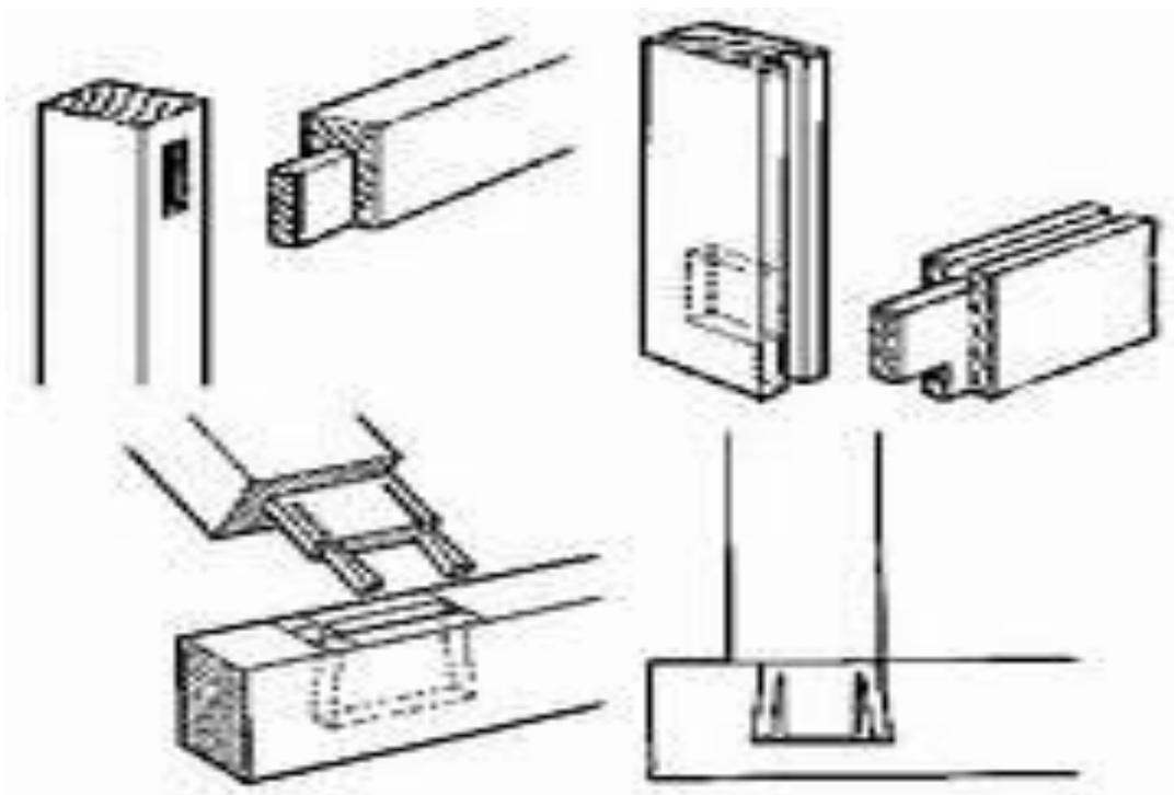
**Ensambladura a cola de milano.**- la que se hace encajando cortada de modo que hacia su extremo se va ensanchando como la cola del milano o golondrina en una muesca o espera hecha de la misma forma en la otra tabla.
