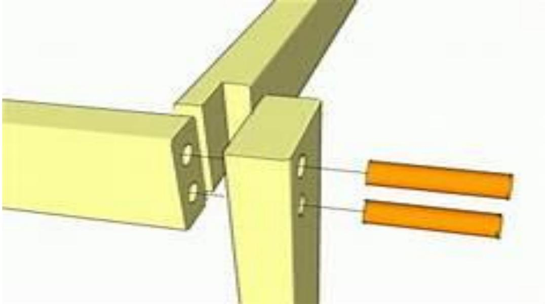
**Ensamble de tope.-** Es el ensamble más sencillo para la unión entre dos tablas que consiste en ensamblar entre cara y canto de la madera dependiendo de lo que se está construyendo.
