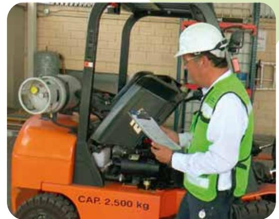
Las revisiones del funcionamiento mecánico, eléctrico e hidráulico en el montacargas se deben de realizar debido a que el uso continuo así lo demanda. La verificación y uso correcto de los aditamentos de seguridad es de vital importancia para la prevención de accidentes, ya que el montacargas se desplaza en diversas áreas, transportando una gran variedad de cargas, para lo cual se emplean diversos accesorios que se verán más adelante.
