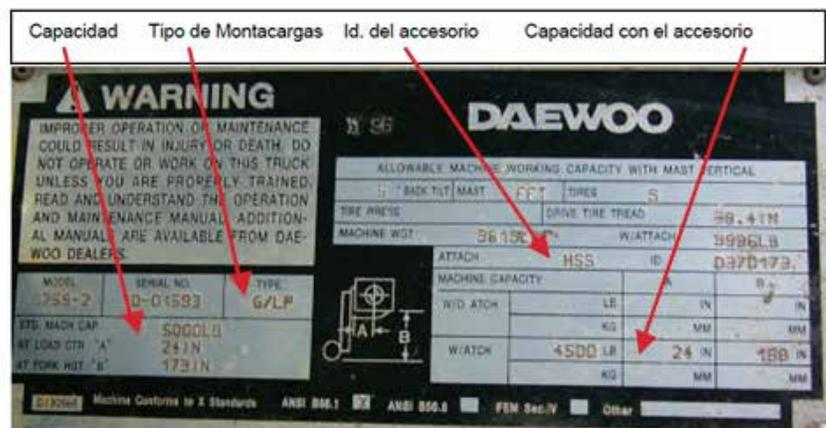
Este montacargas de gas propano puede levantar de manera segura 5,000 libras. 173' pies de altura con un centro de gravedad de 24" desde el frente de las horquillas. Con un accesorio etiquetado "HSS", la carga de seguridad baja hasta las 4,500 libras.
