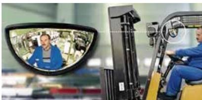
Los espejos sirven de apoyo auxiliar en la visibilidad del operador para el desempeño de una operación segura del montacargas, por lo cual se requiere de una correcta utilización.
