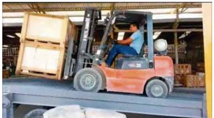
**Operaciones de visibilidad:** Los montacargas deberán operarse en dirección según las características de la carga, de acuerdo a su volumen y altura, si la carga es voluminosa [en altura] aproximadamente mayor a 1.80 m. El montacargas deberá conducirse en reversa, caso contrario al manejar cargas menores a estas dimensiones se transportará de frente.
